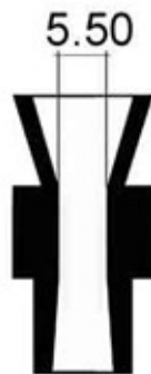
Figura 35: Diametro interno massimo del Venturi
